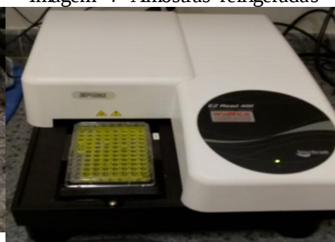
Imagem 6- Espectrofotômetro e microplaca
